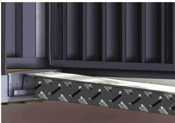
Montage des Winkels mit dem 35 mm Schenkel an der Rampe. Die Rampe schließt ebenerdig mit dem Containerboden ab. Zum Schließen der Tür muss die Rampe wieder aus der Halterung (A) genommen werden.
