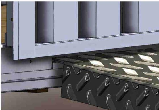
Montage des Winkels mit dem 60 mm Schenkel an der Rampe. Es bleibt eine Kante zum Containerboden. Die Tür kann geschlossen werden.
